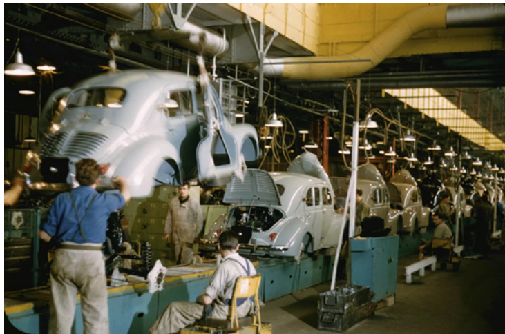
■ Fabrication de 4 CV, ligne de montage mécanique, 1957.
